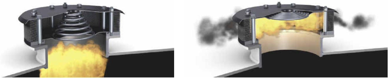
Kommt es im Inneren eines Gerätes zur Explosion, öffnet sich das Ventil und der Druck kann flammenlos durch das Entlastungsventil entweichen
